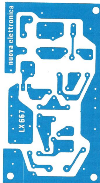
Fig. 6 Disegno a grandezza naturale del circuito stampato richiesto per questo minitrasmettitore.
